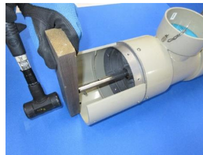
<プラスチックハンマーの使用>
