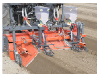
▲畦内2条施肥機RT-400-2Sに装着された表層混和施肥装置(表層混和施肥装置は現在開発中の試作機)
