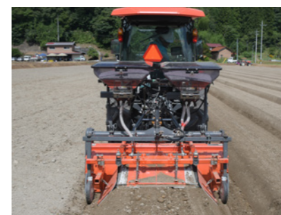
▲超砕土成形ロータリRT-416K(クボタ)+畦内2条施肥機RT-400-2S(鋤柄農機)によるうね内2条施肥
