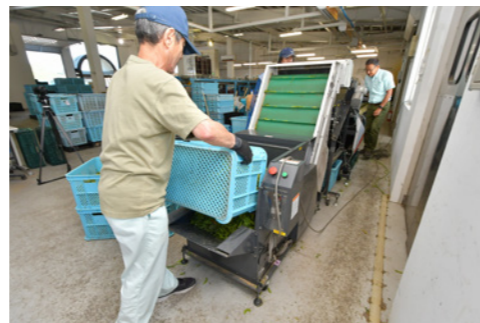
▲供給ホッパは高地上高500mmなので、楽な姿勢で原料の補給が可能
