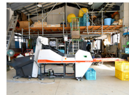
▲秋田県農業試験場に設置されたえだまめ色彩選別機KEDS-1C
