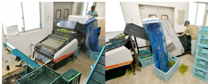
▲粗選別機を共選場のレーンに組み込み、選別精度の検証を行っている
