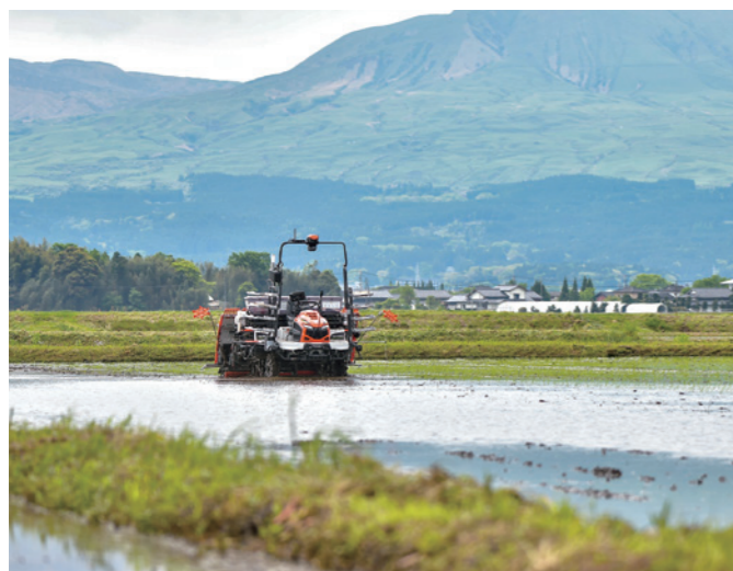
▲自動運転で密播苗の移植作業を行うアグリロボ田植機NW85A
