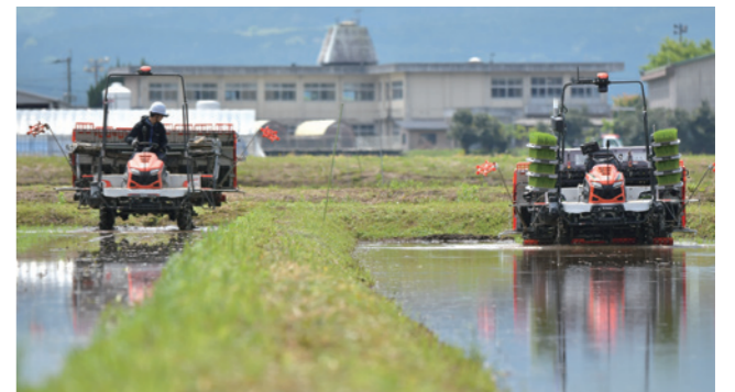
▲NW8S-GS(左)とアグリロボ田植機NW8SA(右)との協調作業
