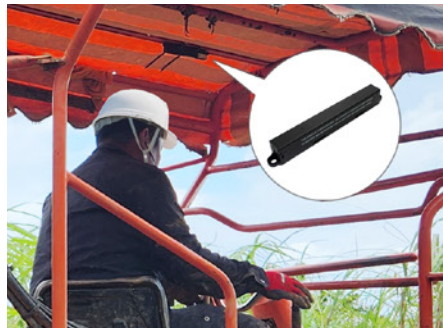
▲ハーベスタに後付けGPS端末を装着してサトウキビの収穫作業を行う
