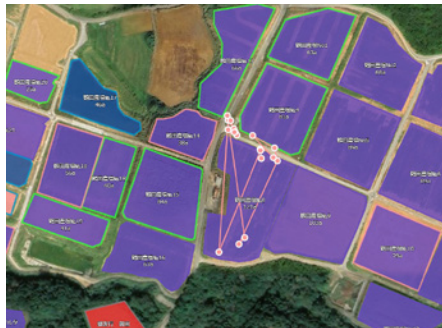
▲10分ごとに送信される位置情報で、ハーベスタの作業経路や作業軌跡が確認できる
