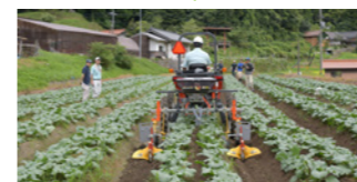
中耕除草・培土同時追肥作業 ●クボタ乗用管理機ナビライダー NR17(クボタ) (トレッド1420mmに設定) ●中耕除草:S4カルチ・もぐらディスク・土ピタ(キューホー) ●培土:ニューイエロー培土機(宮丸アタッチメント研究所) ●施肥:サンソワ(ジョーニシ)
