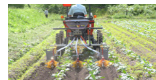
中耕除草・培土同時追肥作業 ●クボタ乗用管理機ナビライダー NR17(クボタ) (トレッド1420mmに設定) ●中耕除草:S4カルチ(キューホー) ●培土:ニューイエロー培土機(宮丸アタッチメント研究所) ●施肥:サンソワ(ジョーニシ)
