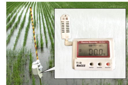
▲実証で使用していた積算気温計。ヒエの発生とイネの出芽予測
