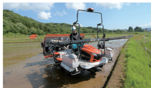
▲タンクから肥料の減り具合が確認できるペースト二段施肥田植機。全層施肥より作業効率が高いと二戸部さんは評価している
