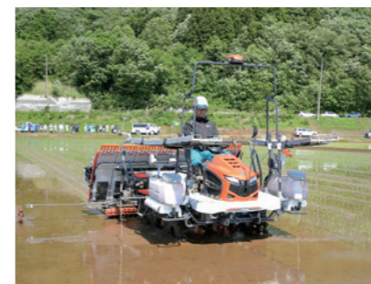
▲田植作業と同時に、側条と深層にペースト肥料を施用するペースト二段施肥田植機(NW8S-Q2-GS)
