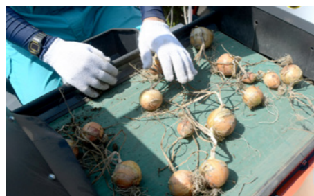
▲座って選別作業ができるKOP-1R。手元のゴミ捨てシュートに不良たまねぎを捨てられる
