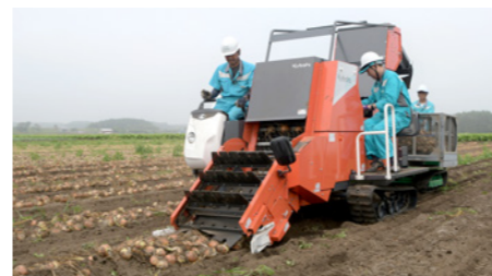
▲マルシヨウ農園の約50aのたまねぎほ場を、KOD-1での掘取り、KOP-1Rでの拾上げ、後続する運搬車での鉄コンテナ運搬まで実働7時間(調整時間含む)で行った
