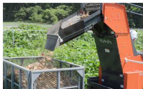
▲排出シュートは電動油圧シリンダで上下に、手で左右に振ることができる
