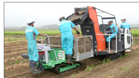
▲たまねぎピッカー追従仕様運搬車XVT500との連携でスムーズな拾上げ作業
