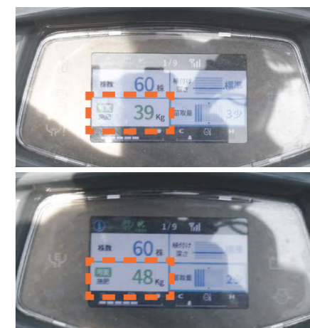
▲可変施肥マップにしたがって行われる可変施肥。ほ場内の場所により、自動で施肥量が変化する
