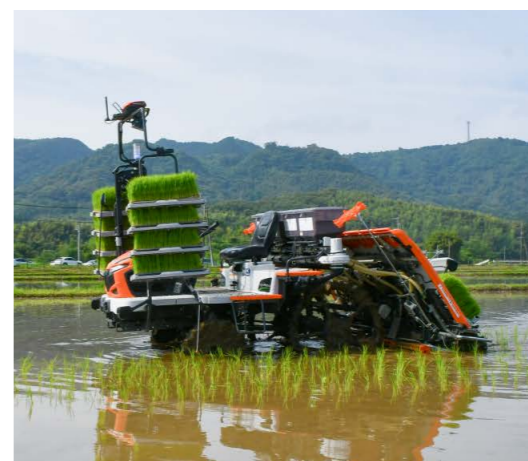
▲植付精度や田植機の操作に差がでないよう、実証区、慣行区ともに無人仕様のアグリロボ田植機(NW8SA-PF-A)を使用
