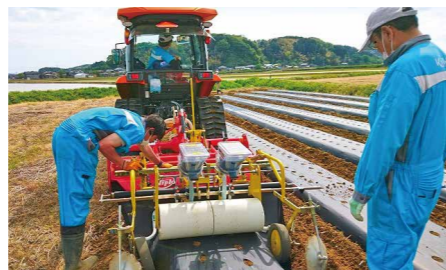
▲新潟クボタによるうね立てマルチ同時播種作業の実演
