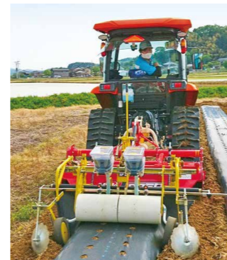
▲GSトラクタは後ろのうね立て、マルチ播種の状況を確認しながら作業が可能
