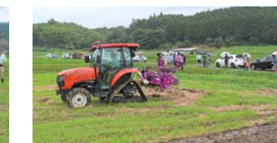
▲GS機能(直進アシスト機能)を搭載したスラッガー GSの実演
