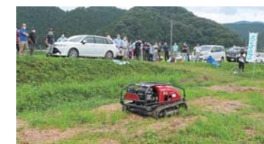
▲ハイブリッドラジコン草刈機「神川」RJ700 走行はモーター、草刈作業はエンジンの仕様。作業傾斜角度に応じ、エンジン傾斜自動制御を搭載し、最大傾斜角度45°を実現
